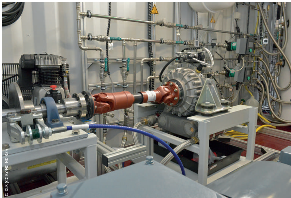
Hydrodynamischer Retarder, der die gewonnene Windenergie in Wärme umwandelt
