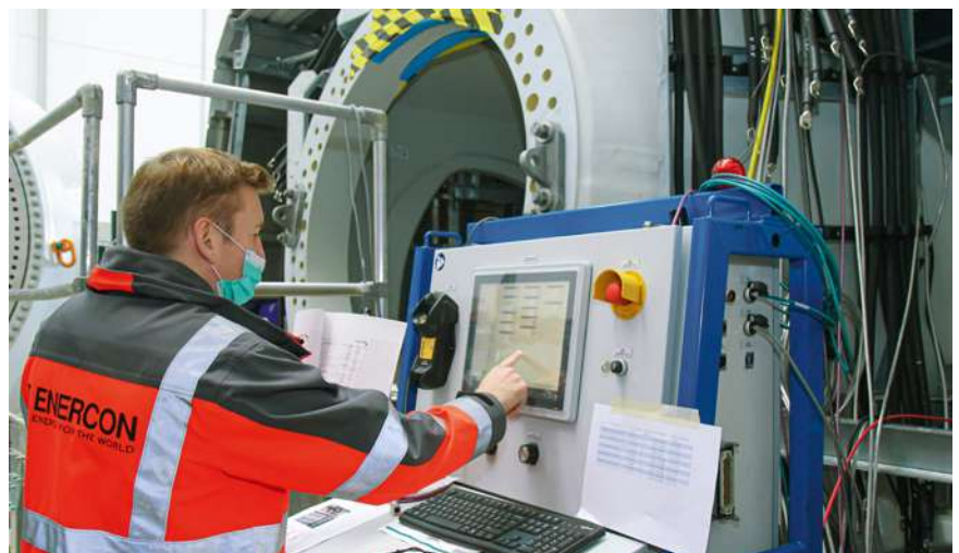
Die Funktionsweise und das Kontrollsystem aller verbauten Systeme der E-Gondel von Enercon werden beim Factory Acceptance Test (FAT) kontrolliert. Foto: Enercon
