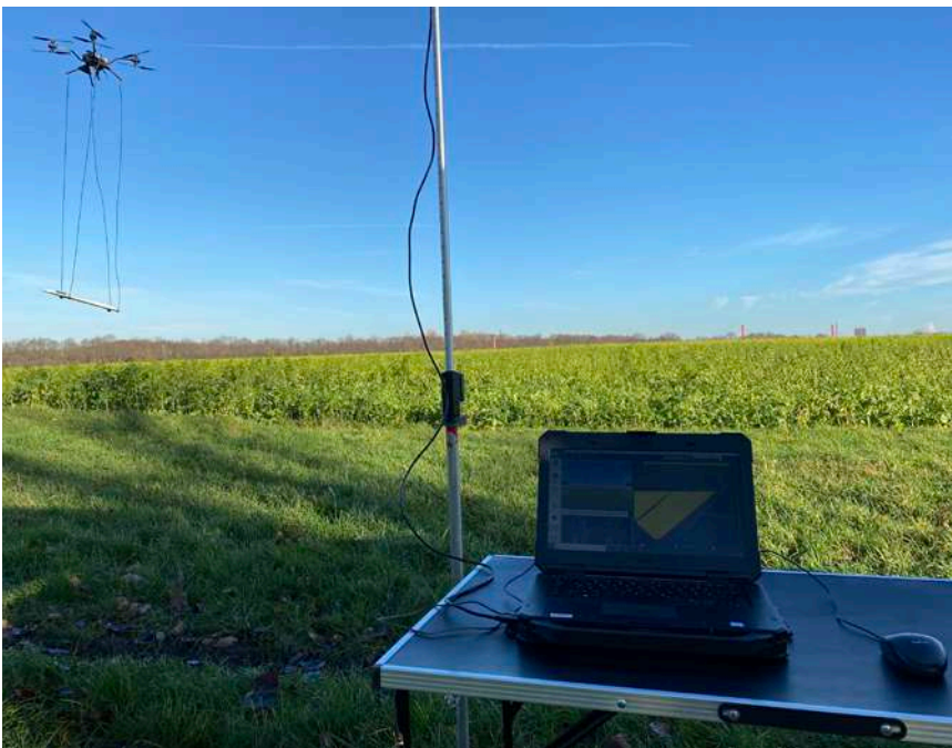
Das Drohnen-Geomagnetik-System fliegt auch über bestellte Felder und ist ca. 10 x schneller als herkömmliche Methoden.
