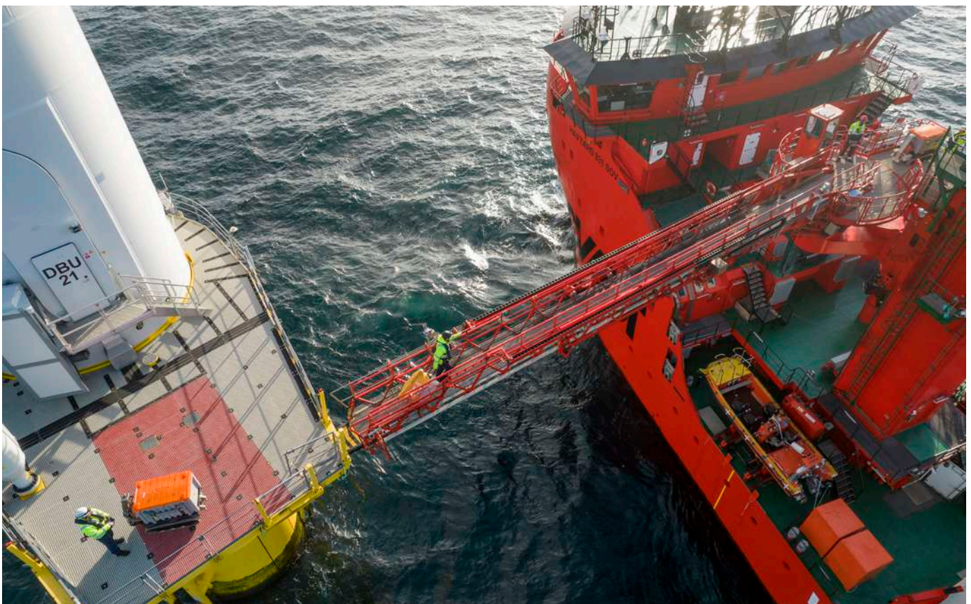
▼ Servicetransportschiff Albert Betz mit Walk-to-Work-Gangway mit ferngesteuerter Lastkatze im Windpark Deutsche Bucht. Foto: Ulrich Mertens
