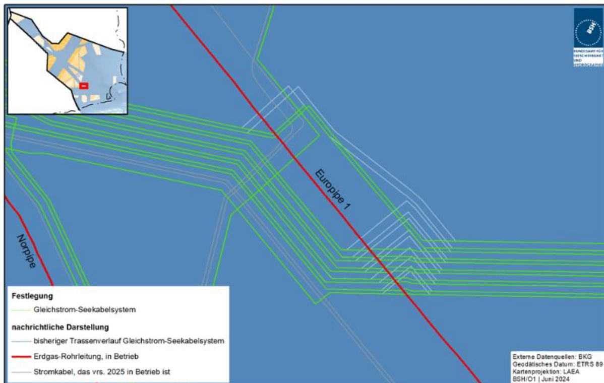
Abbildung 12: Beispiel für Anpassung der Kreuzungen im Bereich der Rohrleitung Europipe 1
